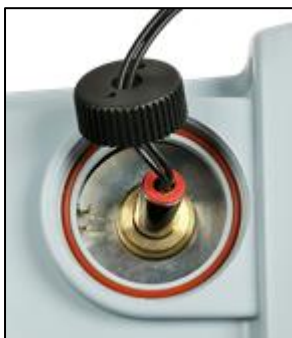
Install the new tungsten filament lamp module.
