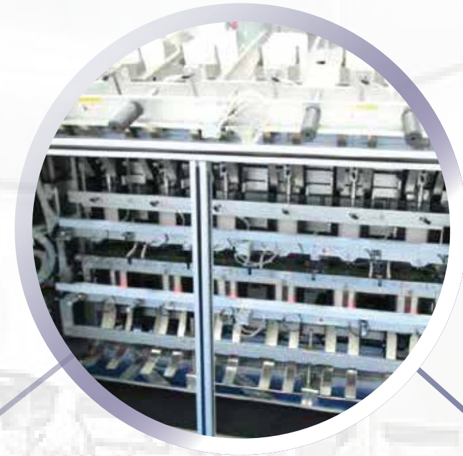
引进面膜一个小时 8000片全自动包装机 器系统
