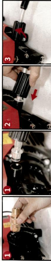
出水管快接安装方法 (接洗车机高的一端)
