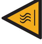
本警告标贴表示泵运转时及运转停止后,而整个泵的温度还很高时,请不要触摸。
