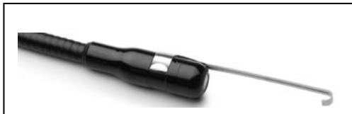
Bild 7 – Anbau eines Zubehörteils auf dem Kamerakopf mit Steckverbindung A
