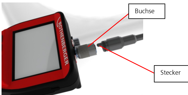
Bild 4- Kabelverbindungen ( Steckverbindung A, schwarz)
