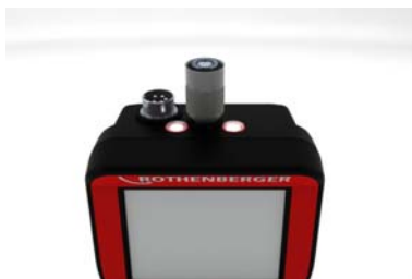
Bild 26 – Anbauposition der Außenbeleuchtung
