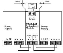
DIMENSION **Y-Series**  12-28V, 40A, DUAL REDUNDANCY MODULE
