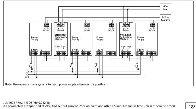
12-28V, 40A, DUAL REDUNDANCY MODULE
