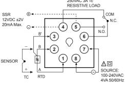
pe) ※Thermocouple: K (CA), J (IC)
