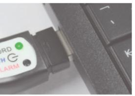
Signalton ertönt und LED leuchtet grün. Logger wird als Wechseldatenträger LOG32TH/LOG32T/ LOG32THP angezeigt.
