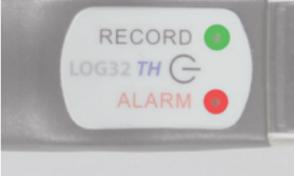
Batteriewechsel OK: Beide LEDs leuchten für ca. 1 Sek. auf und ein Signalton ertönt.
