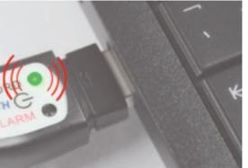
Logger mit USB Schnittstelle verbinden. Signalton ertönt für ca. 1Sek. Die Aufzeichnung wird gestoppt. LED blinkt grün bis das PDF erzeugt ist (kann bis zu 40 Sek. dauern).
