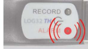
LED blinkt alle 4 Sek. rot. Batterie wechseln.
