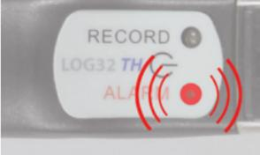
Signalton ertönt alle 30 Sek. für 1 Sek. und die LED blinkt rot (3 Sek.). Messbereich überschritten (nicht bei Standardeinstellung) Grenzwerte können nur via Software LogConnect\* eingestellt werden.
