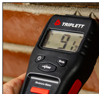
Moisture Meter (pin)
