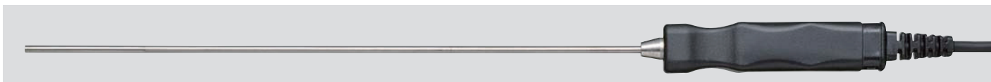
●SK-S101K 一般計測用 -100~700°C φ3.2×L250mm コード1.1m付 No. 8080-24 ¥11,000 (税抜き) (センサ精度 クラス1)
