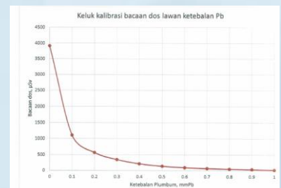
Rajah 1 : Keluk kalibrasi (calibration curve) bacaan dos (µSv) melawan ketebalan Pb (mm) pada jarak 100 cm SSD.
