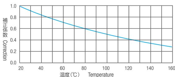
常用使用圧力 (MPa) = 破壊圧力 × 補正係数 × 1/4
