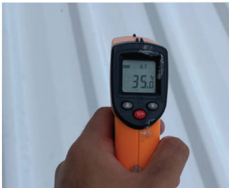
测试结果显示表面温度35°C 温度下降14°C
