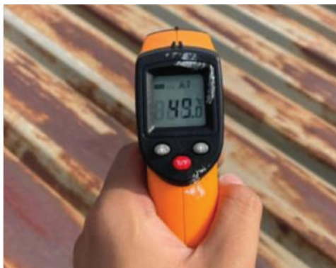
测试结果显示表面温度49°C
