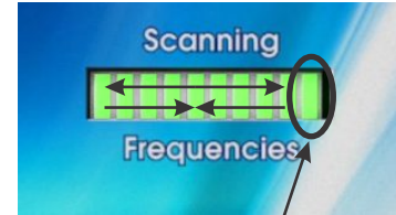
Le témoin LED d'alimentation reste allumé en continu, alors que les autres lumières oscillent d'un côté à l'autre.
