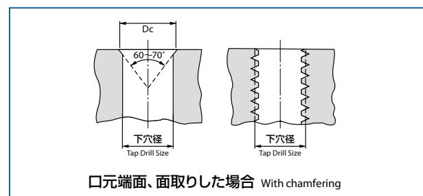
またドリル加工の都合で、118°の面取りが必要な場合は、面取り端面の直径を、ねじサイズ+2ピッチ分にすればかえりを抑制できます。例：M10×1.5の場合、10mm+(1.5×2)=13mm
