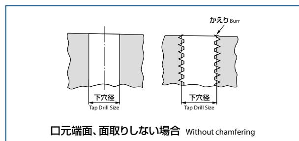
転造タップは塑性変形によりねじ山を形成するため、ワークの口元・端面に面取りがない場合、かえりが生じます。かえりやひげ・バリの発生を抑えるには、60°～70°の角度で面取りを行うことをお勧めします。
