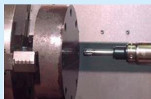
従来の転造タップ (水溶性切削油剤外部給油)
