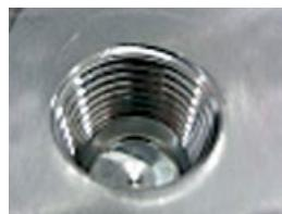
参考：加工トルク(換算値) 674N·m 水溶性切削油剤の他、ペーストでの加工も可能であることを確認済みです。
