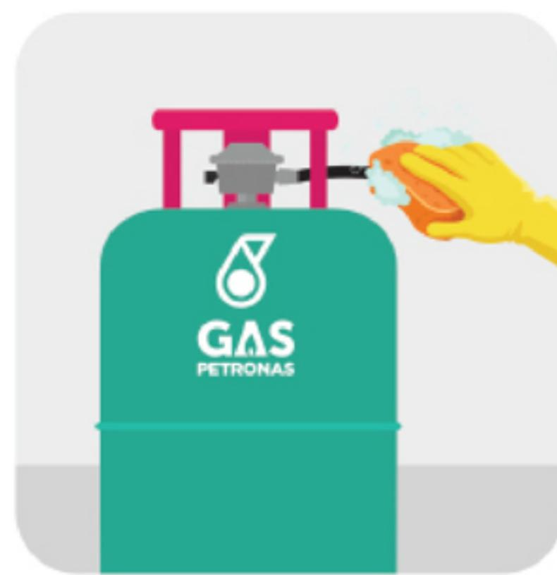
Gunakan ujian air sabun untuk mengesan kebocoran
