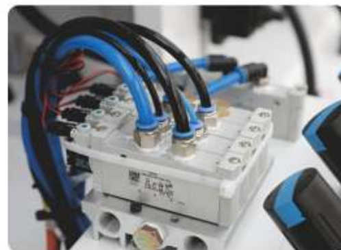
电磁阀配置费斯托 (KE-500H/356)
