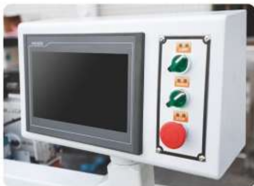
工控系统 Industrial control system
