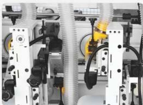
粗、精修边 Rough/fine trimming
