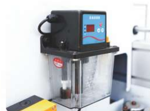
自动注油装置 Automatic oiling device
