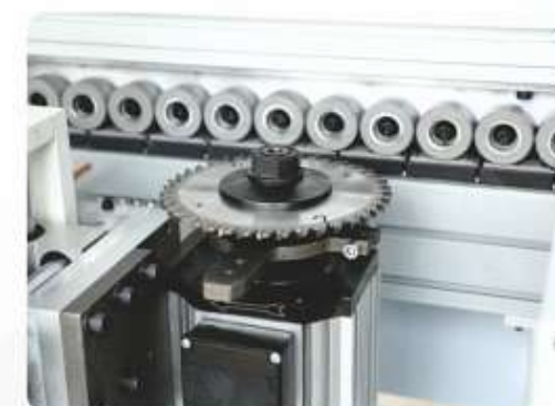
水平开槽 Horizontal grooving
