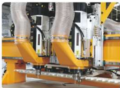
分体式双独立换刀主轴加工 Split-type dual independent tool-changing spindle machining
