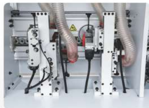
粗、精修边 Rough/fine trimming
