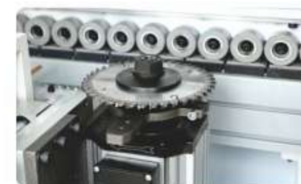
水平开槽 Horizontal grooving
