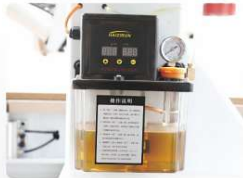
自动注油装置 Automatic oiling device
