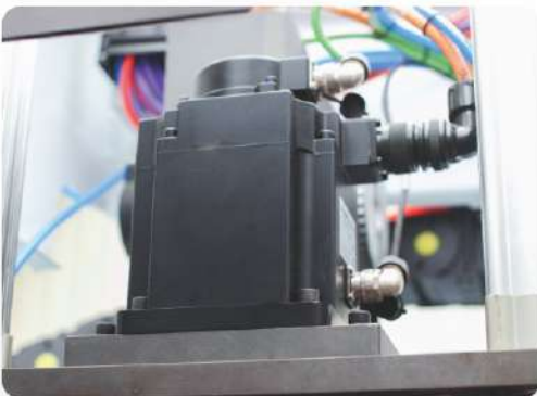
垂直升降伺服电机 Vertical lift servo motor
