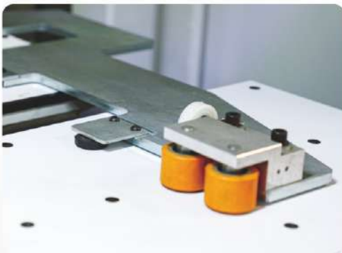
胶轮侧靠装置 Rubber wheel side aligner device
