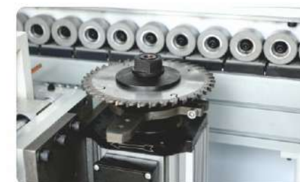
水平开槽 Horizontal grooving
